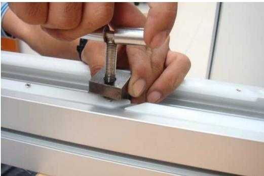
3. Inspeccione que el remache no sobresale de la superficie del raíl de deslizamiento. Inspeccione la superficie superior e inferior del raíl de deslizamiento en busca de metal que sobresalga.
