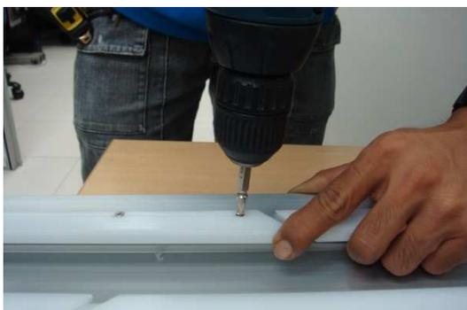
3. Inspeccione que los tornillos no sobresalen de la superficie del raíl de deslizamiento. Inspeccione la superficie superior e inferior del raíl de deslizamiento en busca de metal que sobresalga.
