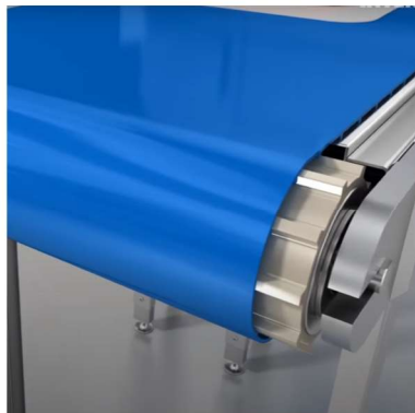
Sistema de tracción positiva ( positive drive)
