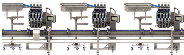
1) LAYOUT : Posición perpendicular de las pesadoras sobre el transportador
