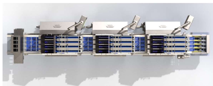
2) LAYOUT : Posición alineada de las pesadoras sobre el transportador / termoformadora.
